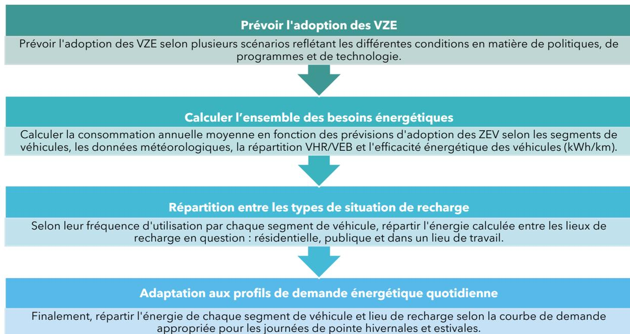
Afin de déterminer les répercussions de l'adoption des VZE sur le réseau électrique, nous avons utilisé des profils diversifiés de distribution de la recharge sur 24 heures, établis à partir de la documentation<sup>13</sup> concernant chaque segment de véhicule et chaque lieu de recharge, ainsi que les résultats du modèle EVA<sup>mc</sup> de Dunsky, avec des ajustements régionaux en fonction de la consommation des véhicules en Saskatchewan (c.-à-d. pour la température et
